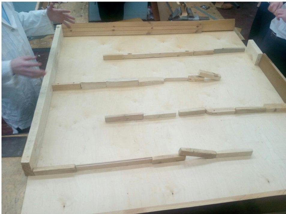
2. Создание реек для стен лабиринта из листа фанеры 1,5x1,5м толщиной 10 мм
